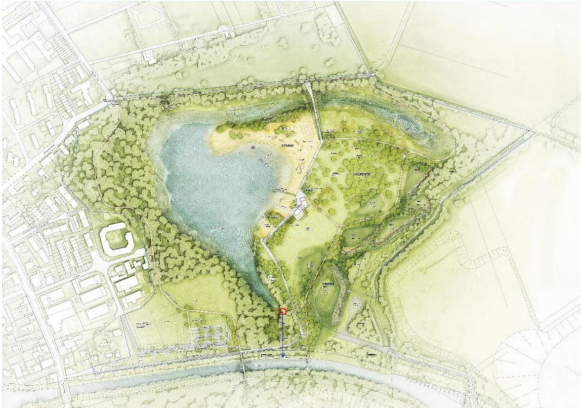
Abbildung 1: Darstellung des Planzustandes (Planstand: 22.03.2024). Der Überlauf ist im Bereich des roten Kreises geplant und verläuft in ungefährender Lage des blauen Pfeils zum Kanal.
