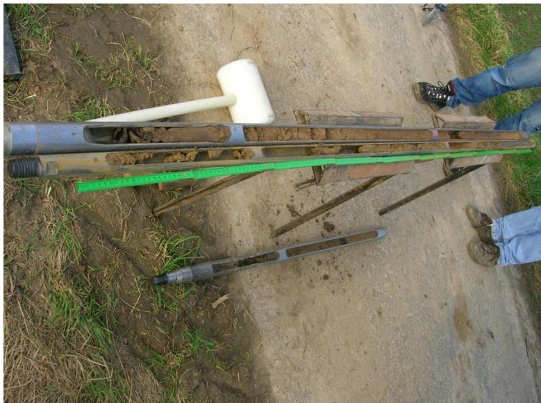
Foto 3: Auslage der erbohrten Bodenschichten bei S 2
