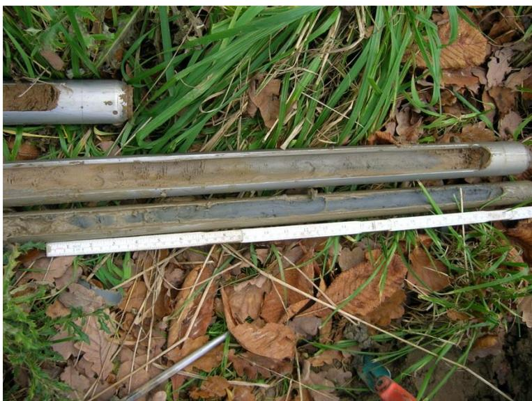
Foto 6: Bodenprofil S 3; der graue Ton in der schmalen Sonde zählt zum Festgestein
