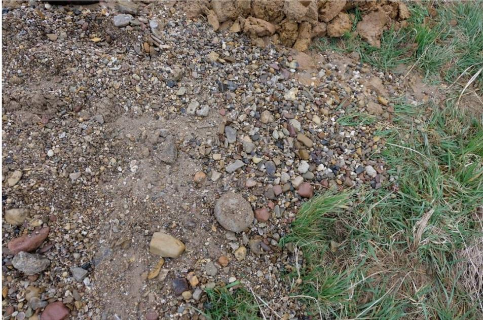
Foto 7: Erbohrtes sandiges-kiesiges Substrat des Grundwasserleiters mit Steinen an der GWM 12
