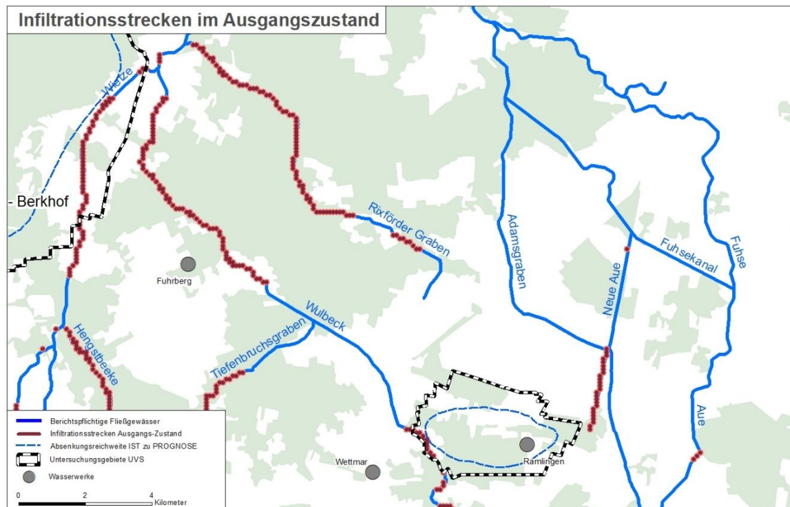
Abb. 12: Infiltrationsstrecken der berichtspflichtigen Fließgewässer im Ausgangszustand
