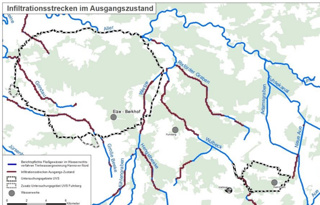
Abb. 7: Infiltrationsstrecken der berichtspflichtigen Fließgewässer im Ausgangszustand
